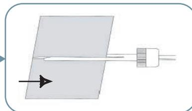
巻き取り棒の先端からシート状癒着防止吸収性バリア（シート）をスリットに挿入する。
