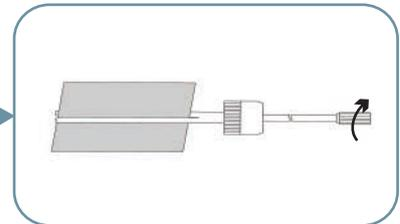
巻き取り棒をゆっくり回転させ、シートを外筒内へ完全に収納する。
