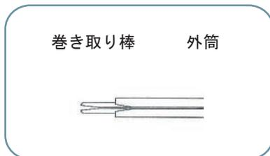
巻き取り棒の先端が外筒より1cm程見えるようにする。
