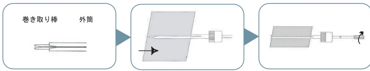
巻き取り棒の先端が外筒より1cm程見えるようにする。
